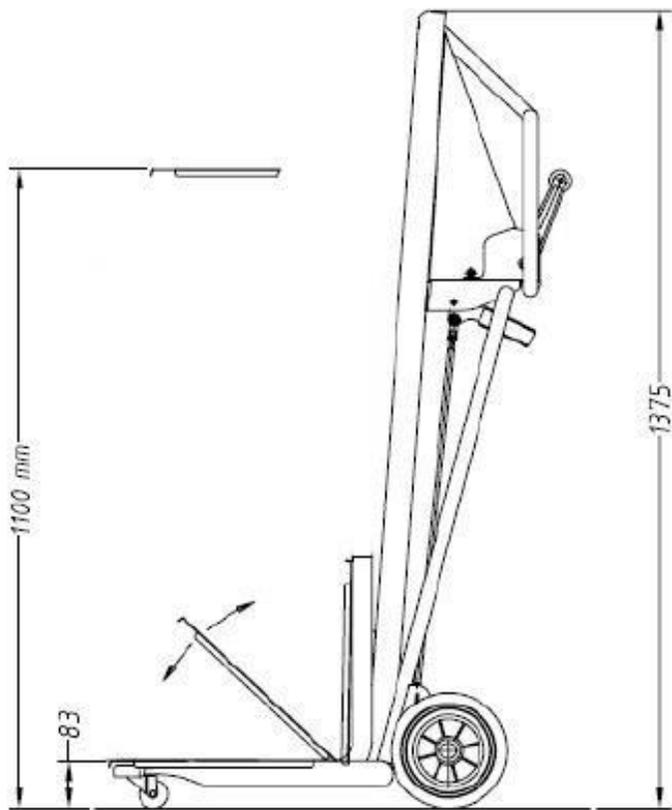
Se puede fabricar con una altura máxima de elevación de 1.600 mm.
